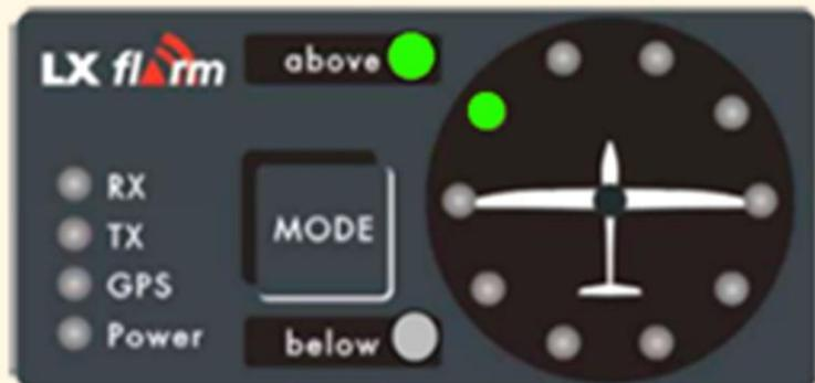
Image du haut : pas de risque, le Flarm signale juste un autre pilote plus haut sur sa gauche mais ne venant pas dans sa direction - Image du bas : danger, un aéronef arrive du dessous à 8 heures.
