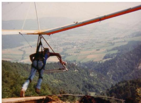
*Barre de pilotage en-dessus du trapèze*
